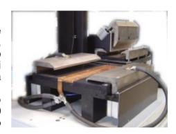
Sono presenti due slitte manuali con nonio graduato per variare l'angolo di incidenza della torcia di saldatura rispetto ai due movimenti principali: longitudinale e trasversale. La range di movimento sull'inclinazione longitudinale è compresa tra 0°e 30°. La range di
